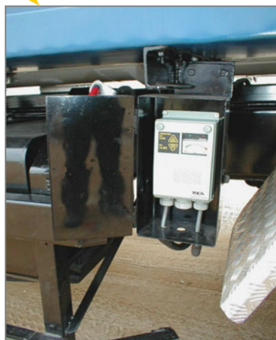
Combustible Gas detector & Alarm (Audio & Visual).
